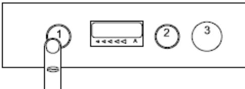
Appuyer à plusieurs reprises sur le bouton 1 pour afficher le message " B TANK SET TEMPERATUR " valeur de consigne température cuve ; pour les modèles dotés de cycle de lavage des couverts il est possible de régler la température de ce cycle en appuyant encore un fois sur le bouton 1 pour afficher C FLATWAIRE.
