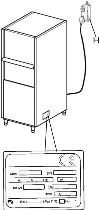
1. La connexion au réseau devra être exécutée au moyen d'un interrupteur général. (H) De type omnipolaire, il interrompt tous les contacts y compris le neutre, avec une distance entre les contacts ouverts d'au moins 3 mm, avec déclenchement magnéto-thermique de sécurité ou accouplé à des fusibles et capable d'être compatible avec les indications de la fiche technique, et de la plaque de l'appareil.
