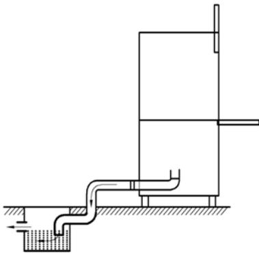
Etant donné que le vidange de la cuve s'effectue par gravité, l'évacuation doit être située à un niveau inférieur à la base de la machine.
